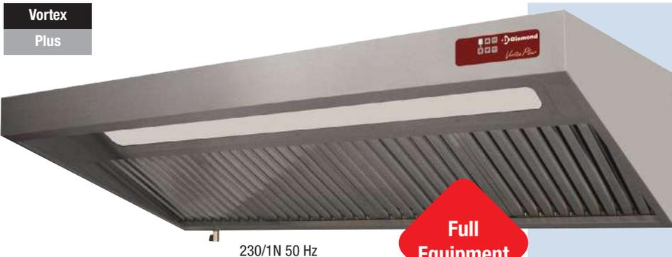
**INFO** - Moteur du ventilateur centrifuge à basse consommation énergétique (Energy saving) - Evacuation maximum 6 mètres de gainage et 1 coude à 90° = 160 Pa. En dotation: fixations murales réglables.
